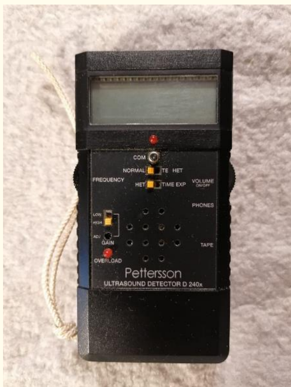
Foto 1. Použitý ultrazvukový detektor Pettersson D240x.
